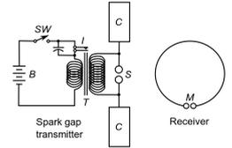
Abbildung 14: Nachweis elektromagnetischer Wellenausbreitung
