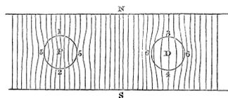
Abbildung 6: Faradays anschauliche Darstellung des Verlaufs der magnetischen Feldlinien in einem paramagnetischen (P) und einem diamagnetischen (D) Körper
